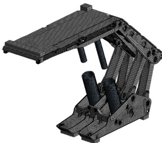
Rys. 9. Model dyskretny sekcji obudowy zmechanizowanej typu BW 16/34 POz z założonym obciążeniem [11]
