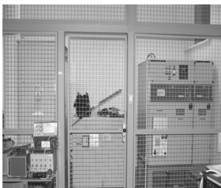
Rys.6. Stanowisko laboratoryjne WN (15kV) oraz wnętrze pola liniowego 15 kV
