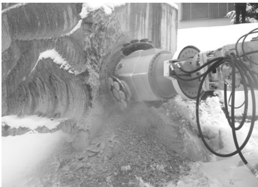
Rys. 14. Widok kombajnu KR 150 z nowym rozwiązaniem głowicy z narzędziami dyskowymi niesymetrycznymi o złożonej trajektorii podczas jednej z prób poligonowych [3]
