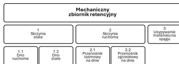
Rys. 2 Uproszczony podział zbiorników mechanicznych
