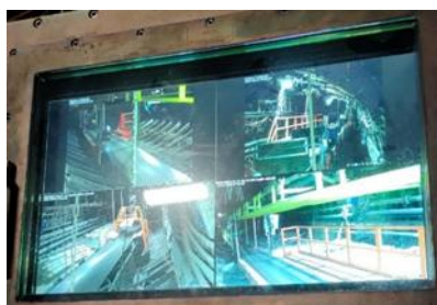
Rys. 5 Monitoring wizyjny jazdy ludzi w LW „Bogdanka” S.A.
