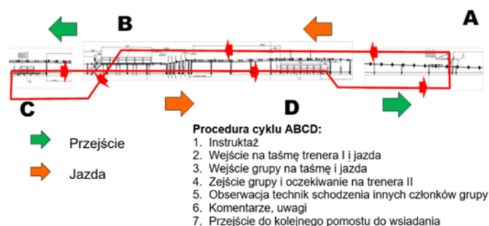
Rys. 8 Stanowisko dydaktyczno-treningowe do szkolenia z zakresu transportu ludzi przenośnikiem taśmowym
