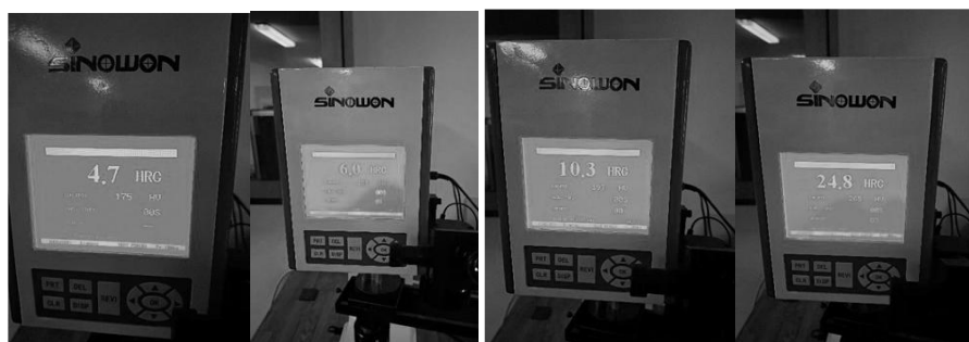
Rys. 4 Wyniki pomiarów na ekranie twardościomierza, wykonanych metodą Rockwella. Widać wzrost w badaniu rozkładu twardości złącza spawanego, począwszy od materiału rodzimego do spoiny
