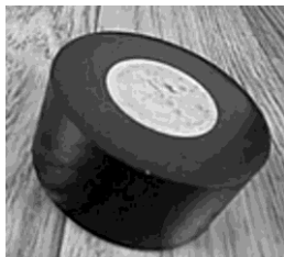
Rys. 5 Widok powierzchni, zainkludowanej próbki po hartowaniu indukcyjnym.
