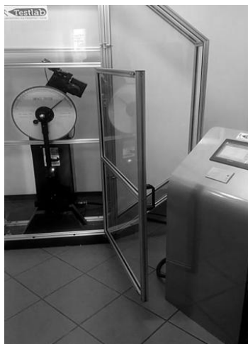
Rys. 7 Widok ogólny stanowiska do badań udarności w laboratorium Katedry Inżynierii Produkcji
