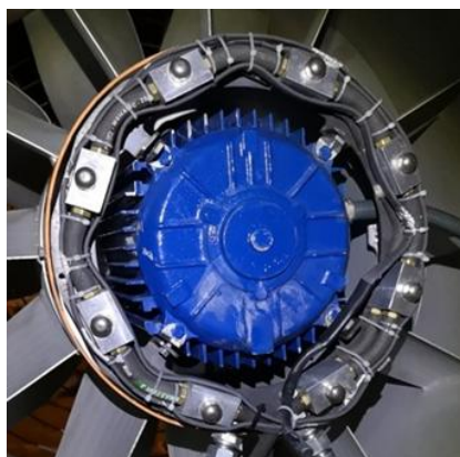
Rys. 4 Umieszczenie nowej głowicy nukleacyjnej w armatce śnieżnej
