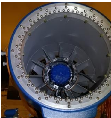
Rys. 3 Umieszczenie dysz nukleacyjnych w konwencjonalnej armatce SUPERSNOW
