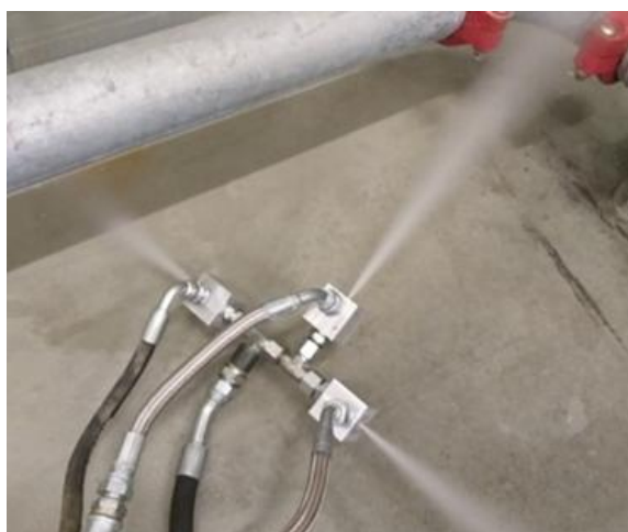
Rys. 11 Badania pracy strumienia nowo zaprojektowanej dyszy atomizującej w warsztacie SUPERSNOW
