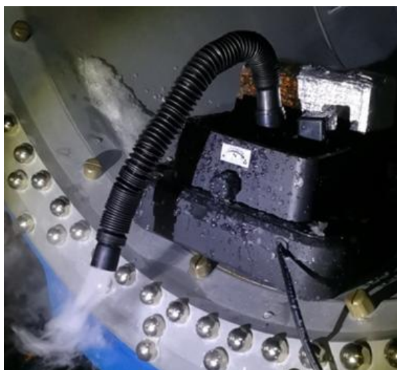
Rys. 9 Widok nawilżacza powietrza po demontażu zbędnych komponentów
