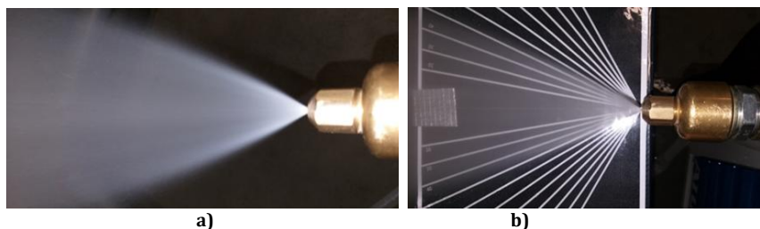
Rys. 5 Badania pojedynczych dysz na stanowisku laboratoryjnym: a) widok ogólny; b) pomiar kąta rozpylania
