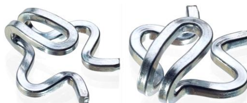
Rys. 5 Zawlecзка HERT wykorzystana do analizy wpływu orientacji wydruku
