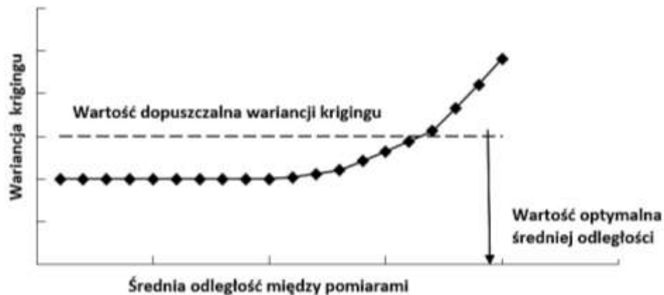
Rys. 16.3 Przykładowy wykres zależności wariancji krigingu od średniej odległości między pomiarami
