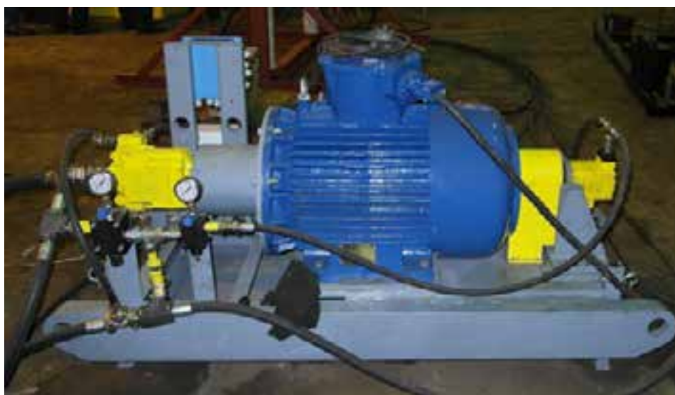
Rys. 8.3 Silnik hydrauliczny do napędu przyrządu
