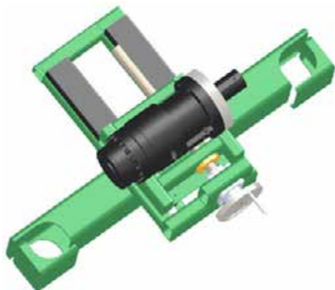
Rys. 8.17 Suport z wózkiem i akuatorem zamocowany do ramy
