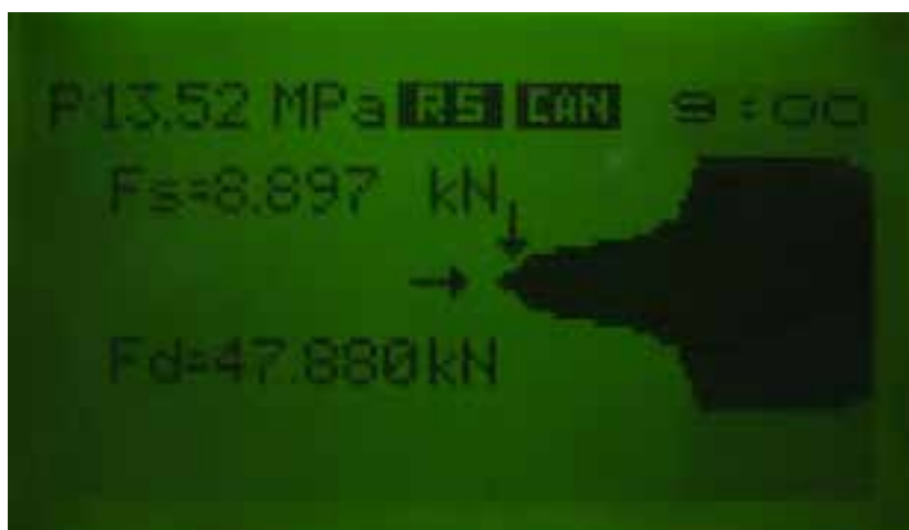
Rys. 8.30 POp-1 ekran LCD – plansza główna w czasie pomiaru
