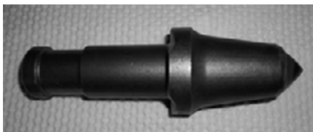
Rys. 8.34 Nóż styczno-obrotowy zastosowany w głowicy przyrządu POU-BW/01-WAP
